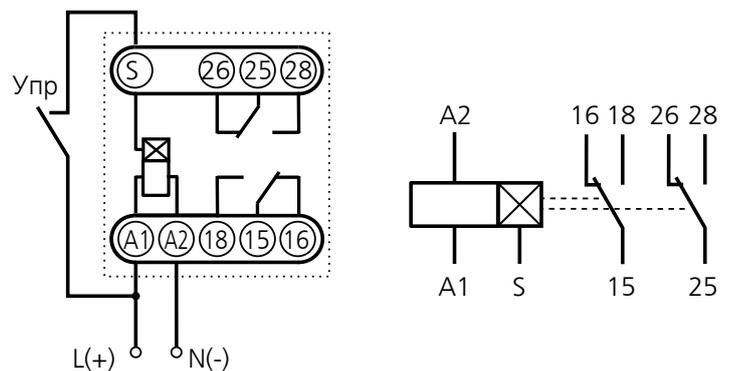
**ВНИМАНИЕ!** Для исключения сбоев в работе реле при коммутации индуктивной нагрузки (электромагнит, электромагнитный клапан и др.), подключите непосредственно к клеммам нагрузки помехоподавляющую цепь в виде последовательно соединенных резистора 100...200 Ом 2Вт и неполярного конденсатора 0.1...0.22 мкФ 400...600В
